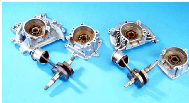
CHYBA PALIVA - Obrázek 2 Stáří prošlého paliva 60 - 65 dní
