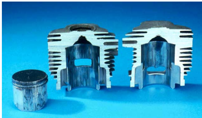
PETROLOVÉ ZÁVADY - Obrázek 4 Výfuková strana pístu motoru s portem
