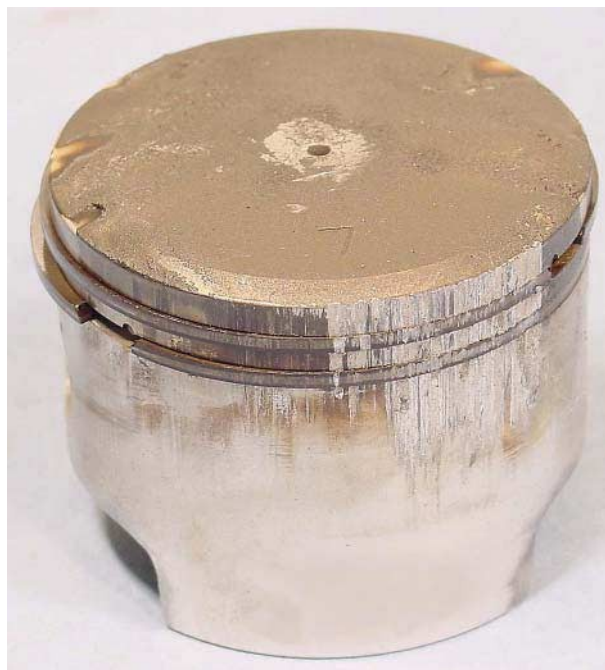
LEAN FAILURES - Obrázek 1 Strana výfukového portu
