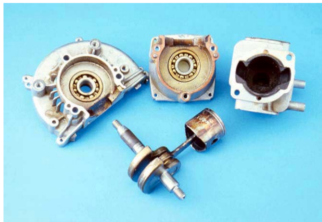
CHYBA PALIVA - Obrázek 3 Běžné palivo 60 - 90 dní staré
