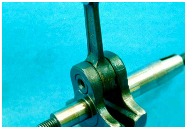
LEAN FAILURES - obrázek 4 Velký konec spojovací tyče
