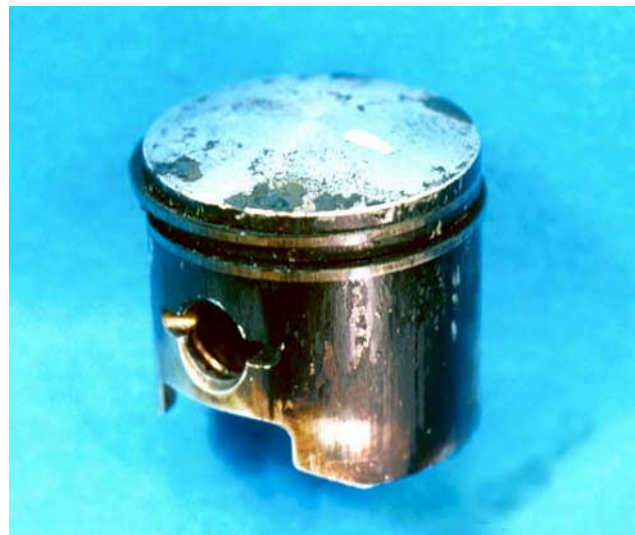
ZÁVADA OLEJE - Obrázek 4 25 hodin komerčního použití
