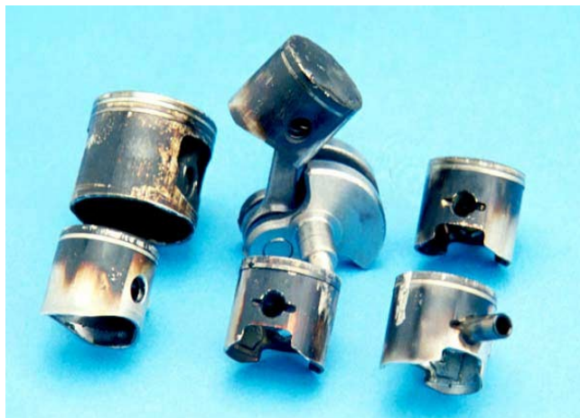
ZÁVADA OLEJE - Obrázek 2 15-75 hodin používání
