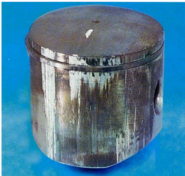
ZÁVADA OLEJE - Obrázek 1 Nedostatek oleje
