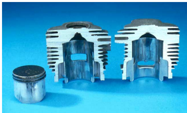
PETROLOVÉ ZÁVADY - obrázek 5 Portovaný píst motoru Sací strana pístu
